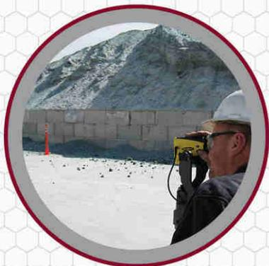
Я могу обследовать 15 тонную кучу гравия менее чем за час. Мы также измеряем исходное сырье и делаем быстрые выборочные проверки путем измерения расстояний и высот, используя только TruPulse 360.”
